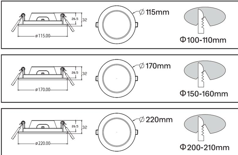
1. Die Leuchte auspacken und am Montageort einen geeigneten Deckenausschnitt gemäß Abb. erstellen. Dabei bitte beachten: Mindestabstände zur Leuchte in der Decke: 30 mm seitlich und 40 mm nach oben.
