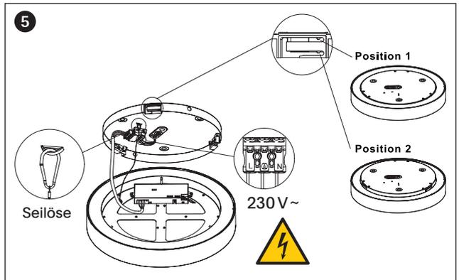
1. Die Leuchte auspacken, die Trägerplatte durch Drehen gegen den Uhrzeigersinn lösen und der Leuchte entnehmen.
